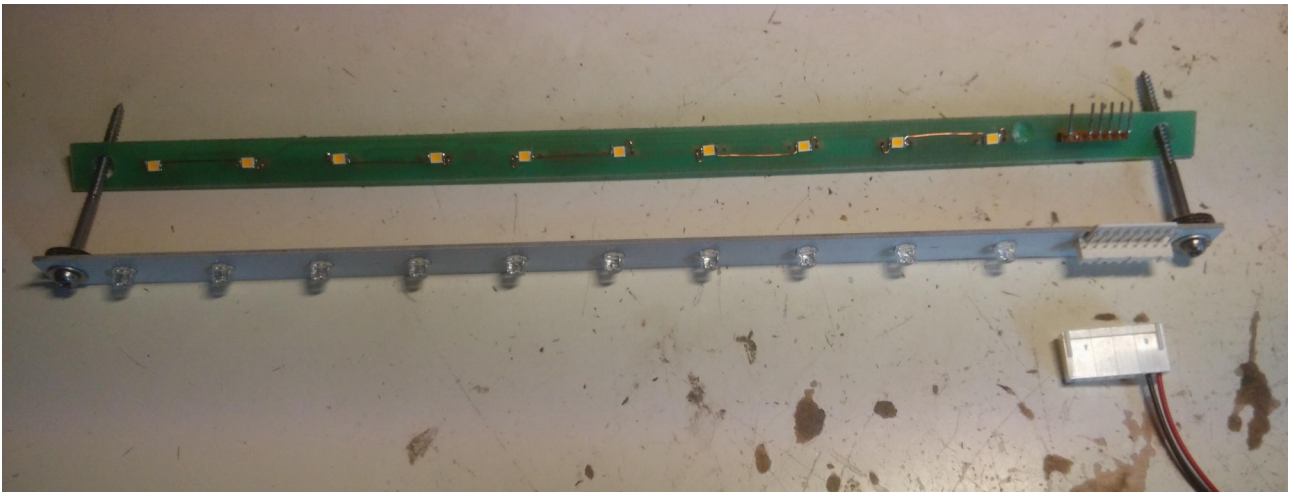
Le nouveau et un ancien (réparé avec des leds cms).
